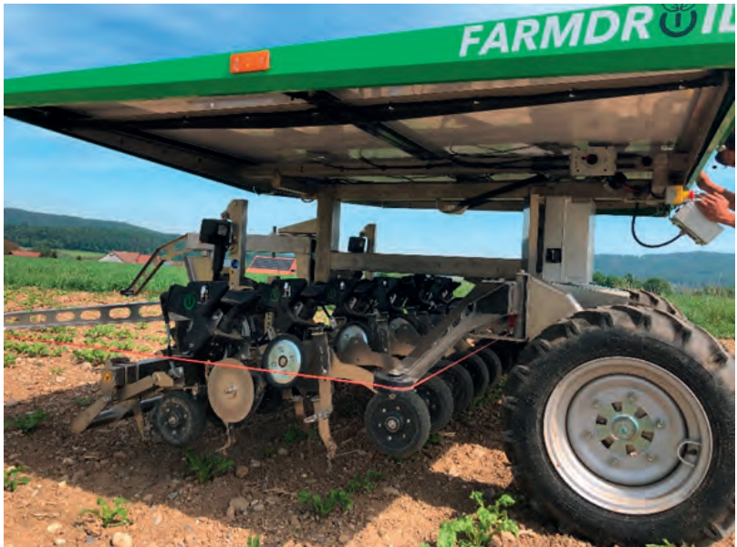
Le robot Farmdroid permet de lutter contre les adventices dans différents types de cultures. (Photo: FiBL)
